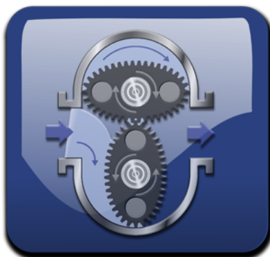
Obr. č. 1 – Merací princíp objemového prietokového meradla
